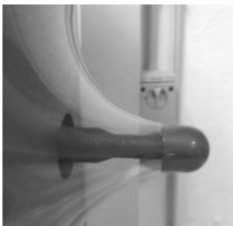
Рис. 5. Зразок плівки при визначенні зусилля утримання плівкою
