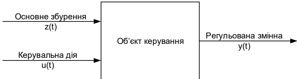
Рис. 7.2. Параметрична схема по каналу регулювання тиску кип'ятіння суслу в сушварильному котлі.
