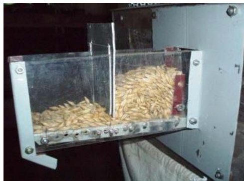
Рис. 3.3. Конструктивна схема та загальний вигляд пристрою з вібруючим дном для забезпечення подачі зерна в камеру подрібнення
