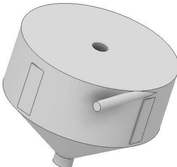
Рис. 3.29. Модель розрахункової області сушарки з комбінованим підведенням сушильного агенту
