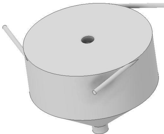
Рис. 3.12. Модель розрахункової області сушарки з трьома підвідними патрубками сушильного агенту
