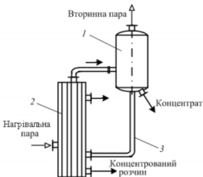
Рис.5.2.4.4. Випарний апарат трубчастого типу з вільною та примусовою циркуляцією [52]
