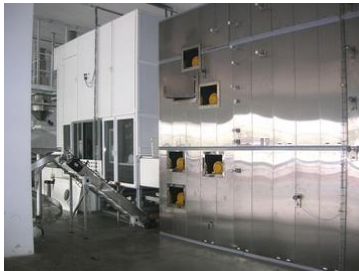
Рис 1.3 Розстійно-пічний агрегат Г4-РПА-Н4-30/20
