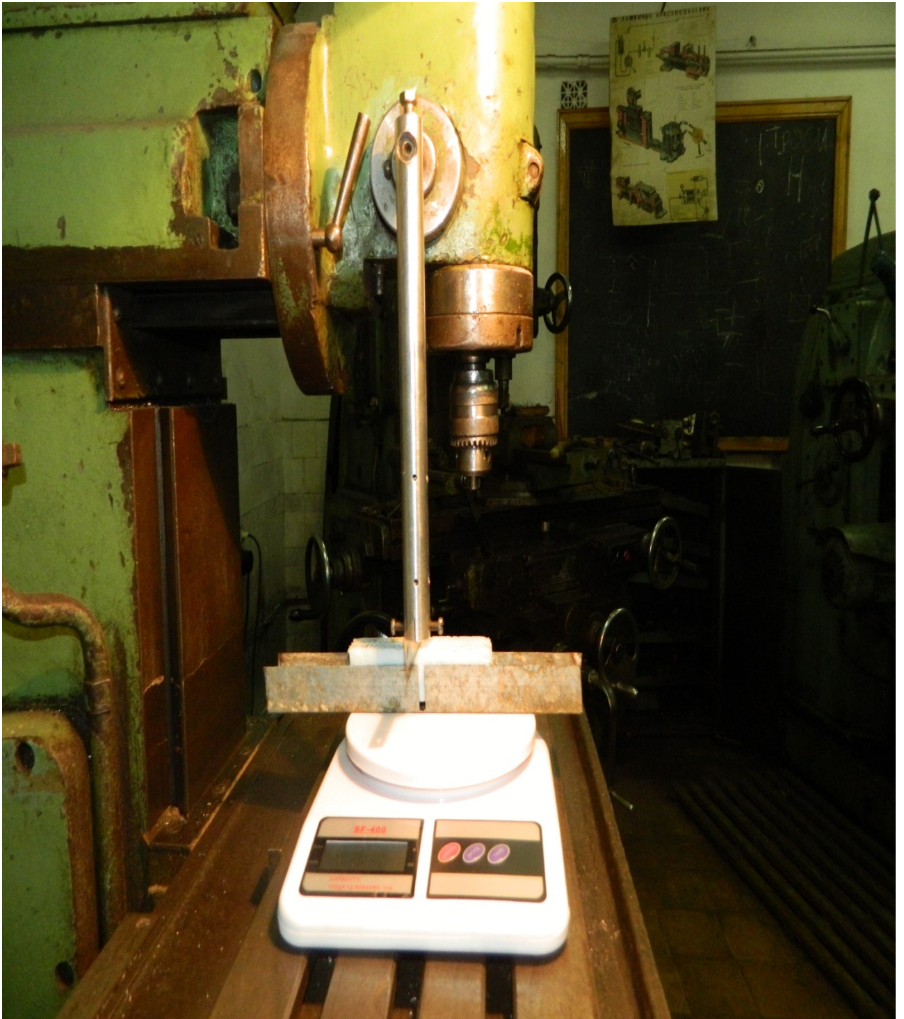
Рис. 3.6. Дослідна стенд з модельним тілом – пінопласт з оболонкою на виході леза
