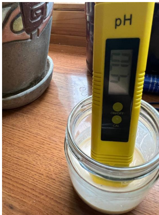
Рисунок 1.8 – Визначення активної кислотності за допомогою портативного рН-метра
