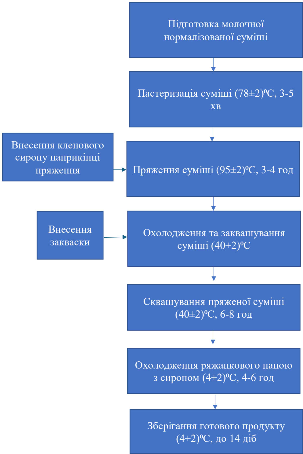
Рисунок 1.9. – Принципова технологічна схема виробництва ряжанкового напою з кленовим сиропом
