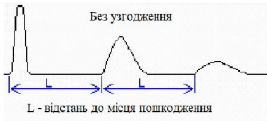
Рис. 3.6 – Рефлектограмма лінії без узгодження вихідного опору
