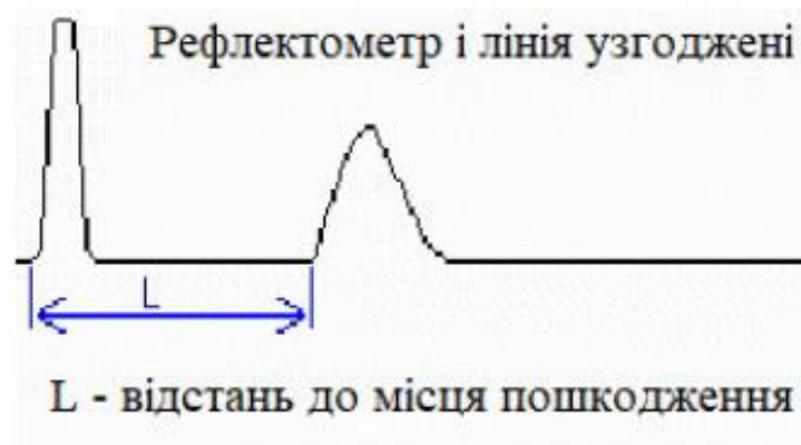
Рис. 3.7 – Рефлектограмма лінії з узгодженням вихідного опору
