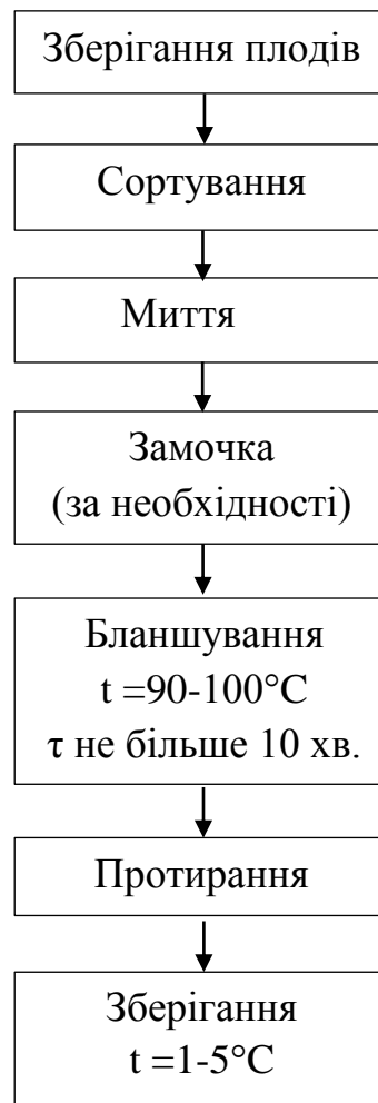
Рис. 3.1. Принципова схема виготовлення пюре
