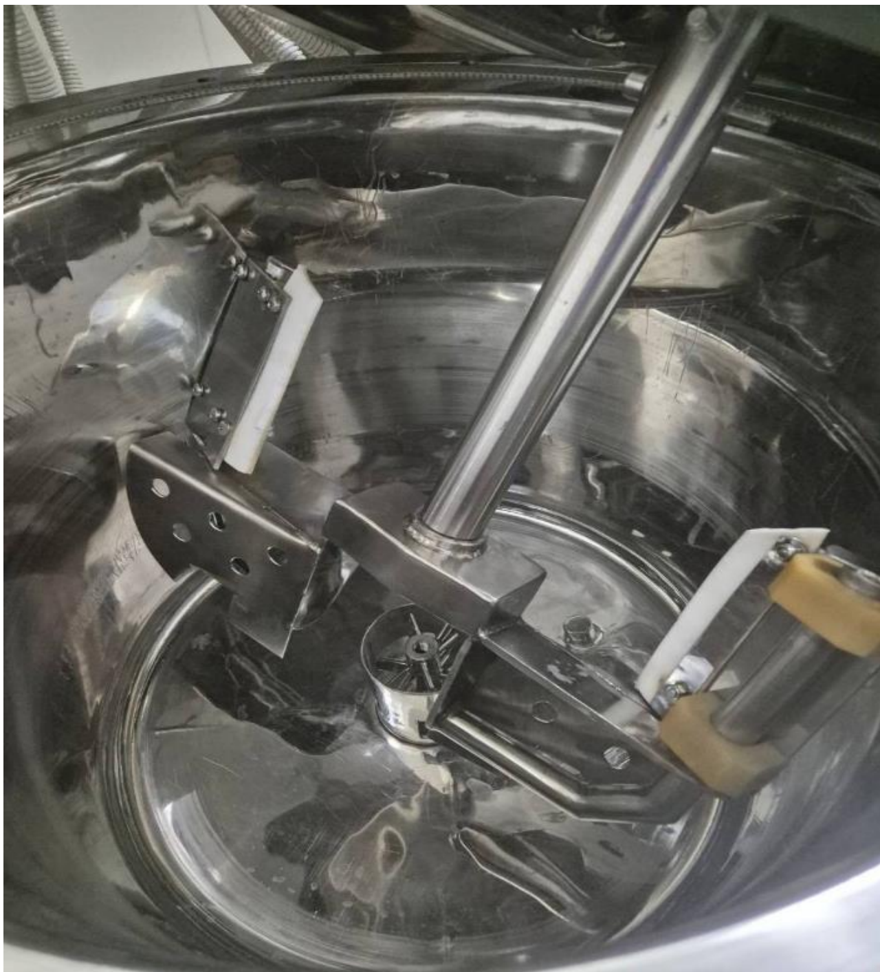
Рисунок 4.3 – Мішалка та гомогенізатор у реакторі-змішувачі, виробництва ЧП Стройторгсервіс
