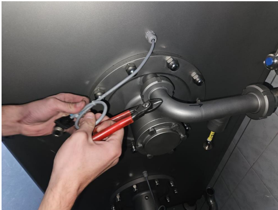
Рисунок 4.5 – процес підключення датчика ТСП ПТ100, для скребкового охолоджувача.
