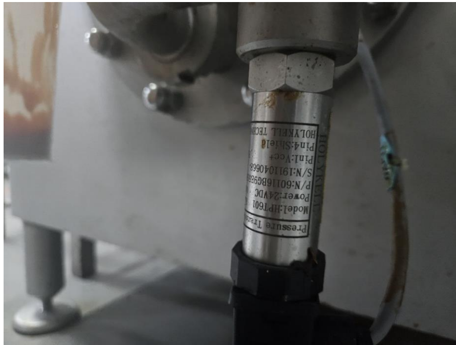
Рисунок 2.1.6 – Датчик тиску НРТ601 який вмонтовано в трубу скребкового охолоджувача.
