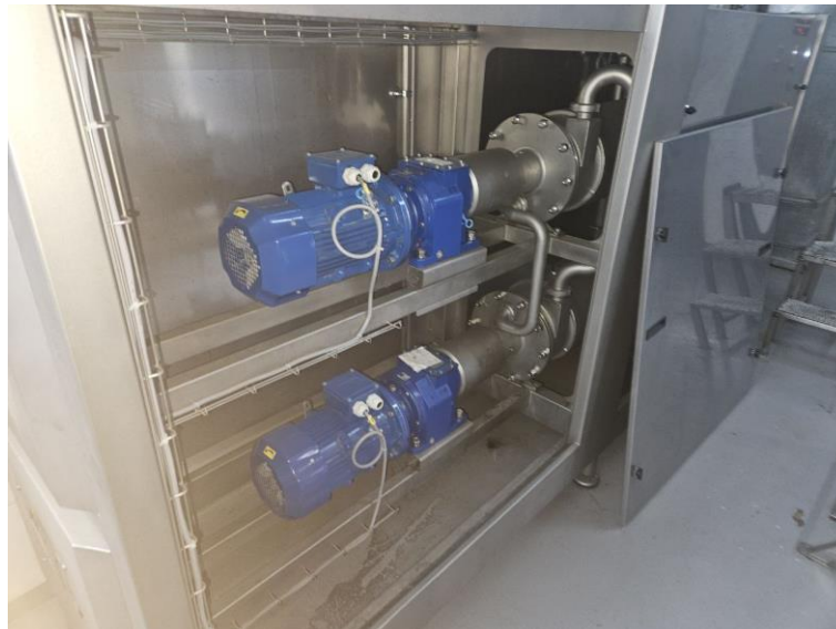
Рисунок 1.1.5 – привода скребкового теплообмінника
