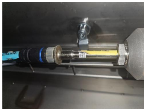
Рисунок 2.1.3 – Датчик, який вмонтований в трубу скребкового охолоджувача.
