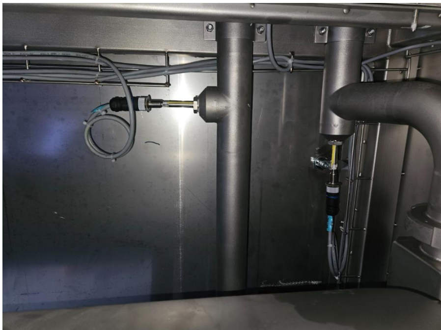
Рисунок 4.6 – підключені та вмонтовані дачики температури для продукту та хладогену.
