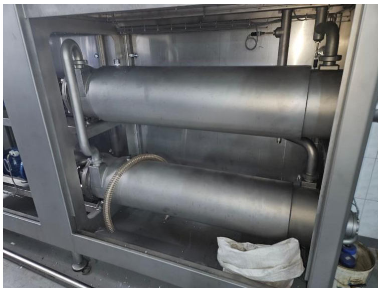
Рисунок 1.1.4 – скребковий теплообмінник без кришки
