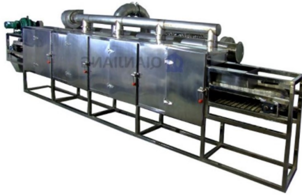
Рис. 3.3 Багатошарова стрічкова сушарка “Perry”
