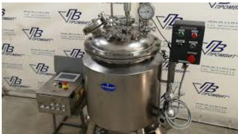
Рис. 5.3.5. Реактор для приготування розчинів фармацевтичний компанії «Промвіт»
