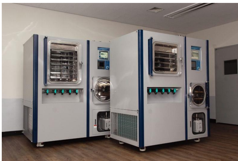
Рис. 5.2.2.2. Пілотна ліофільна сушка LP30R
