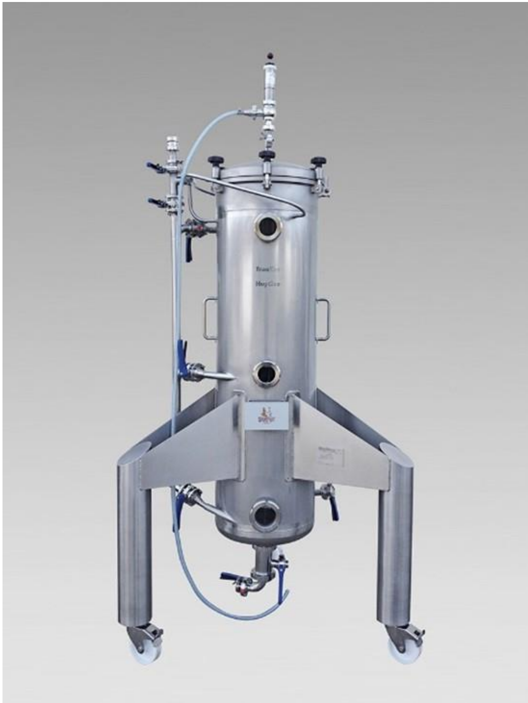
Рисунок 3.3 - Обладнання для холодного охмелення (Noptower)
