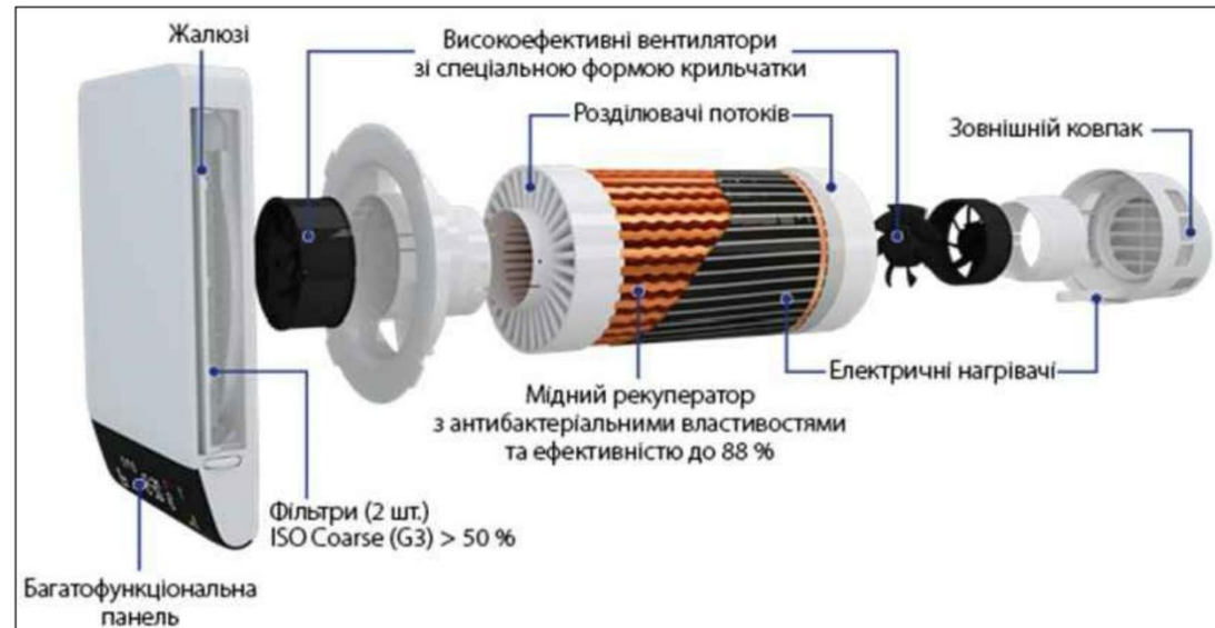
Рис.3 – Конструкція рекуператора Вентс Breezy 160-E Smart
