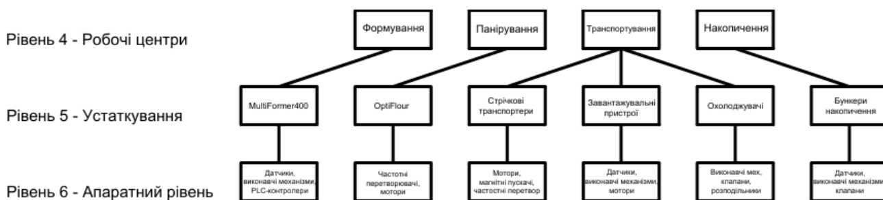
Рисунок 2.4 Нижні рівні (4-6) ієрархічної моделі обладнання лінії нагетсів відповідно до ISA-106/95
