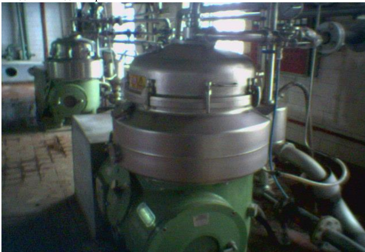
Рис. 2.2 – 2 сепаратора типу HDA 75 06 016, потужність двигуна – 45 кВт (АТЗТ "Одеський дріжджовий завод")
