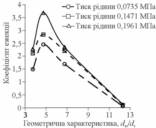
Рис. 10. Залежність об'ємного коефіцієнта ежекції від відношення d_{kz}/d_c : тиск рідини (0,735, 1,47 \text{ і } 1,96) \cdot 10^5 Па
