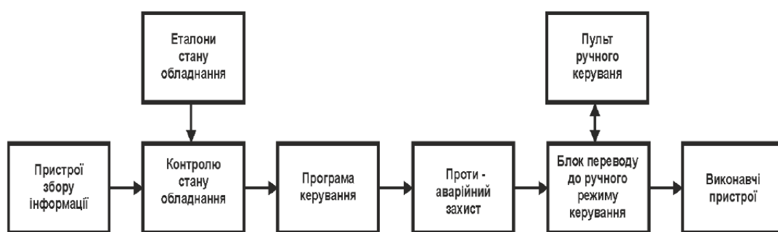
Рис. 5.2. Принципова структурна схема інформаційних потоків при керуванні роботою обладнання
