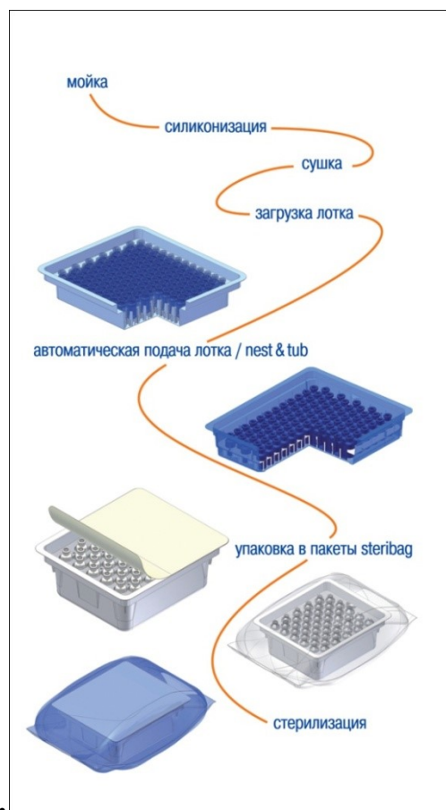
Рис. 9.1. Схема процесу підготовки ампул EZ-Fill
