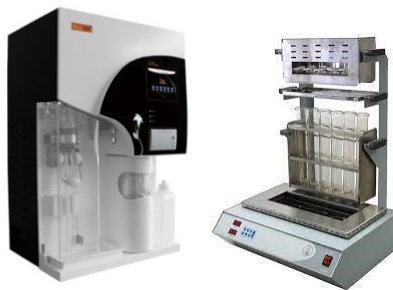
Рис. 7.3. Автоматичний аналізатор амонійного азоту методом Кьельдаля Nanon K1100F з блоком розкладання SH220N.
