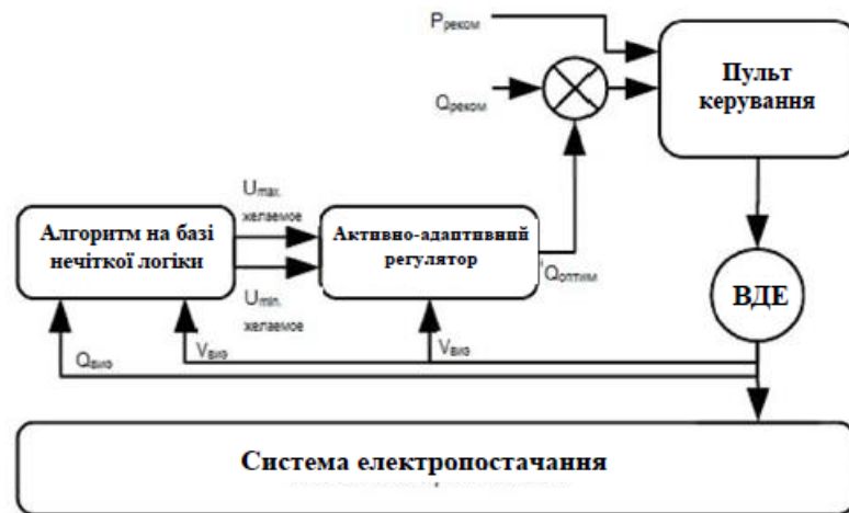
Рисунок 1.2 – Загальна схема активно-адаптивного регулювання, запропонована G. Ramі
