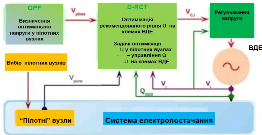
Рис. 1.3 – Схема регулювання D-RCT
