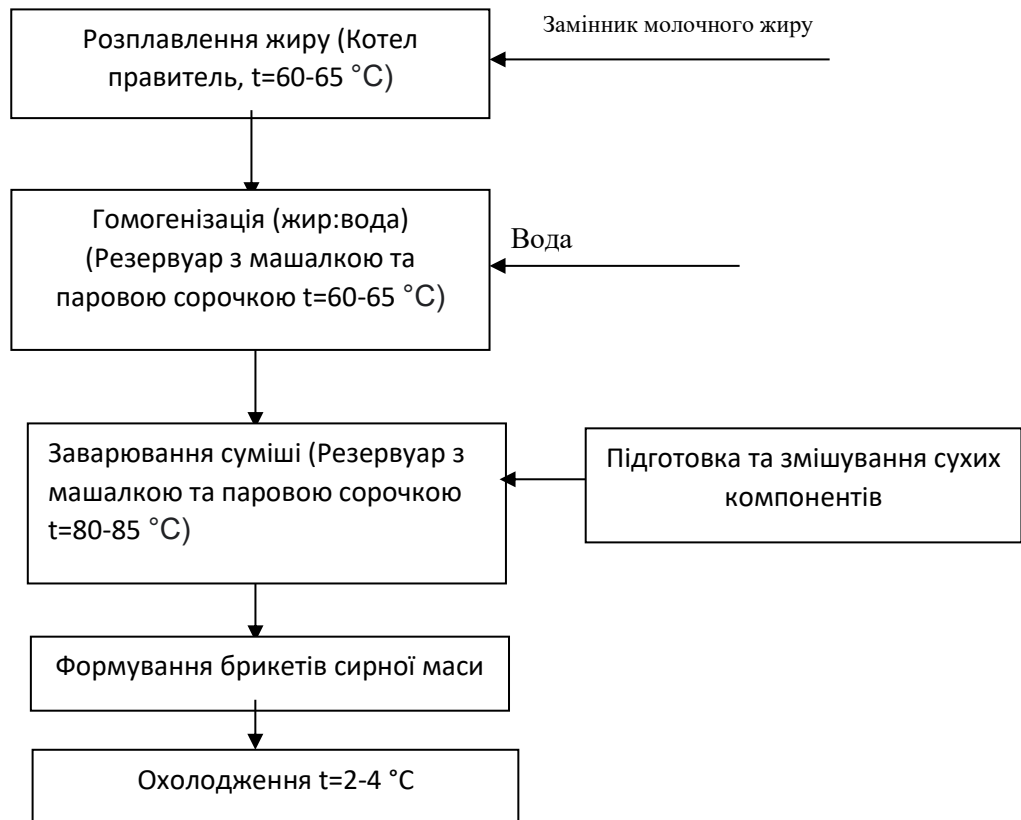
Рисунок 4.1- Загальна технологічна схема виготовлення БССМП
