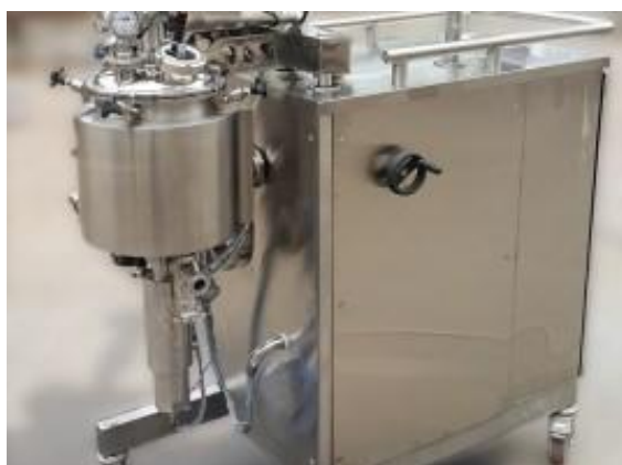
Рис.9.2. Реактор – гомогенізатор лабораторний KFT 10 об'ємом 10 л [139]
