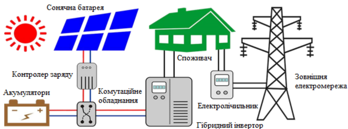
Малюнок 19. Схема автономної, з'єднаної з мережею (гібридної) СЕС.
