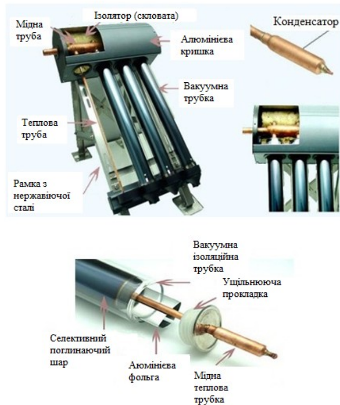
Малюнок 12. Огляд елементів вакуумних сонячних колекторів.
