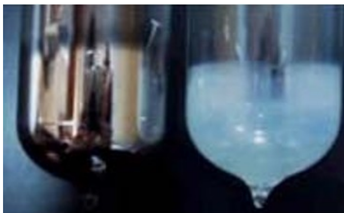
Малюнок 10. Визначення справності вакуумної трубки для сонячного колектора: трубка зліва справна, трубка справа – ні.
