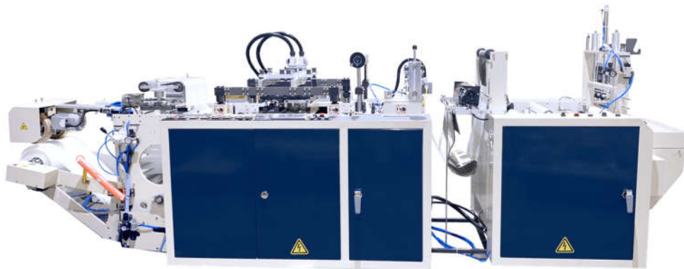
Рис. 1.11. Автоматична лінійна машина для виготовлення заготовки надувної захисної упаковки SSCR-50-L1+BUB
