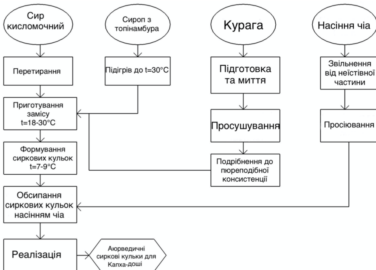
Рисунок 3.11 – Технологічна схема виробництва аюрведичних сиркових кульок призначених для Капха-доші.
