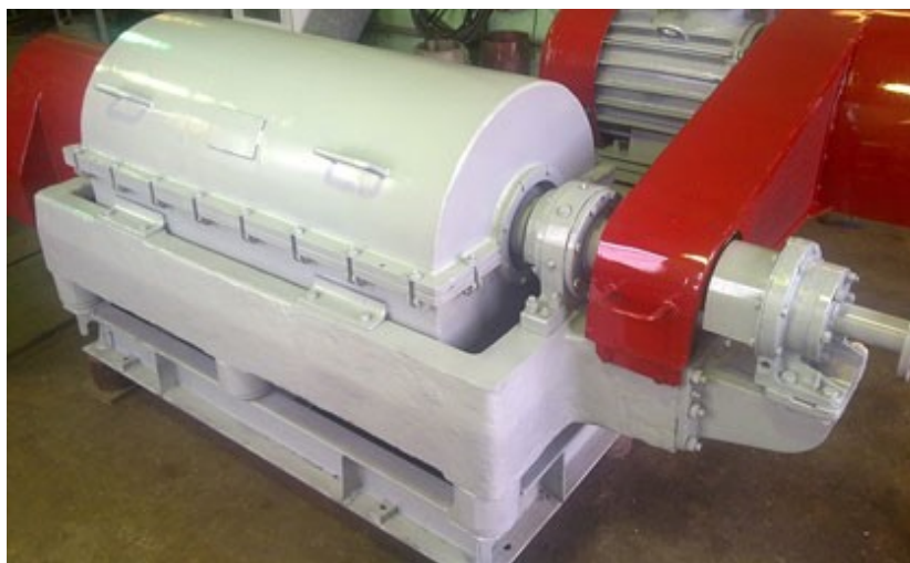
Рис.9.4. Зовнішній вигляд центрифуги ОГШ-1350Ф
