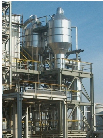
Рис. 9.9. Кристалізатор з примусовою циркуляцією (FC)
