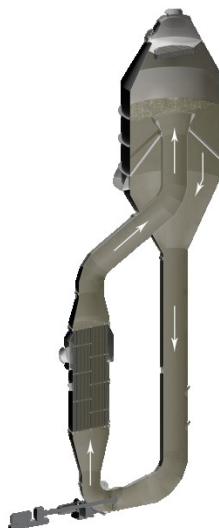
Рис 9.10. Кристаллизатор з примусовою циркуляцією (FC)
