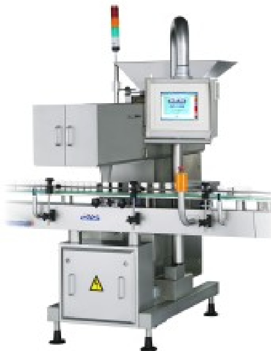
Рис. 12.2. Автомат для фасування капсул у флакони CVC 1220
