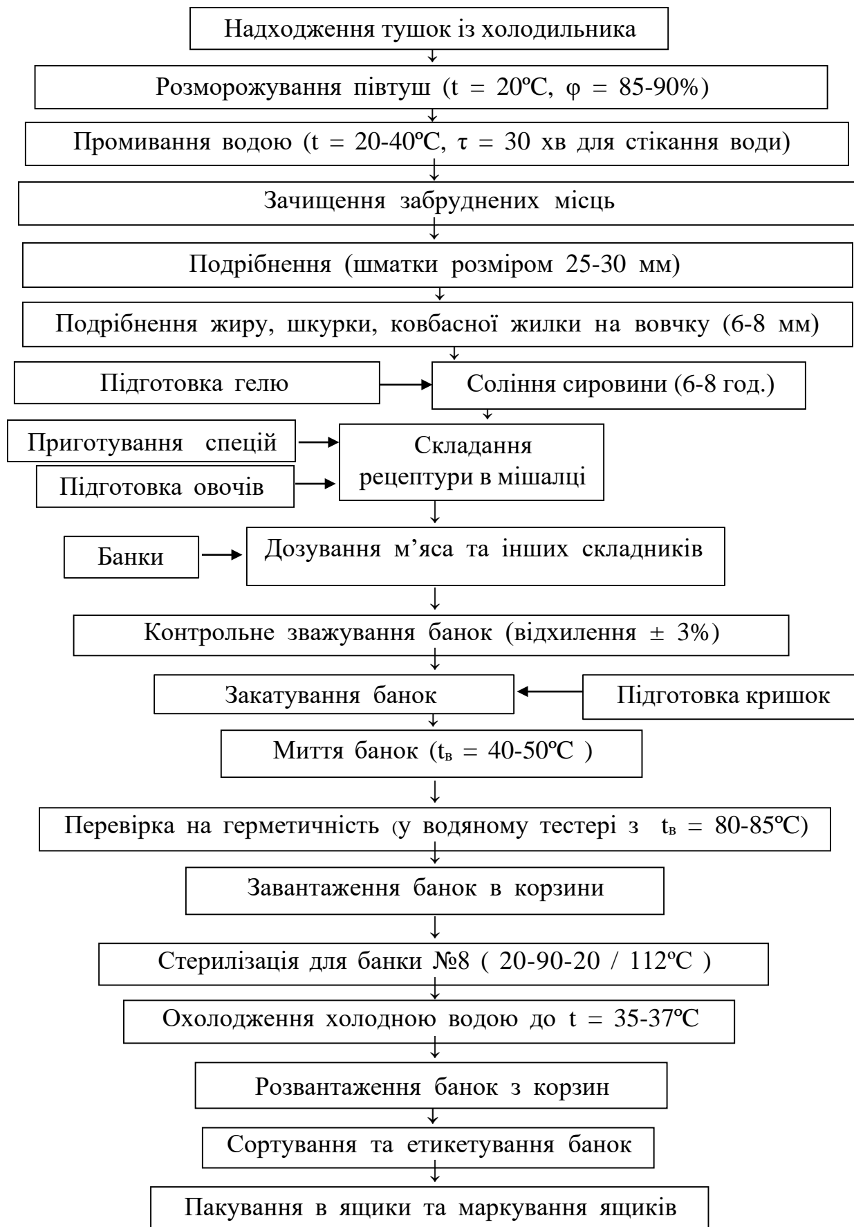
Рис. 4. Принципово-технологічна схема виробництва консервів “Свинина ароматна” та “Сніданок сіверський”
