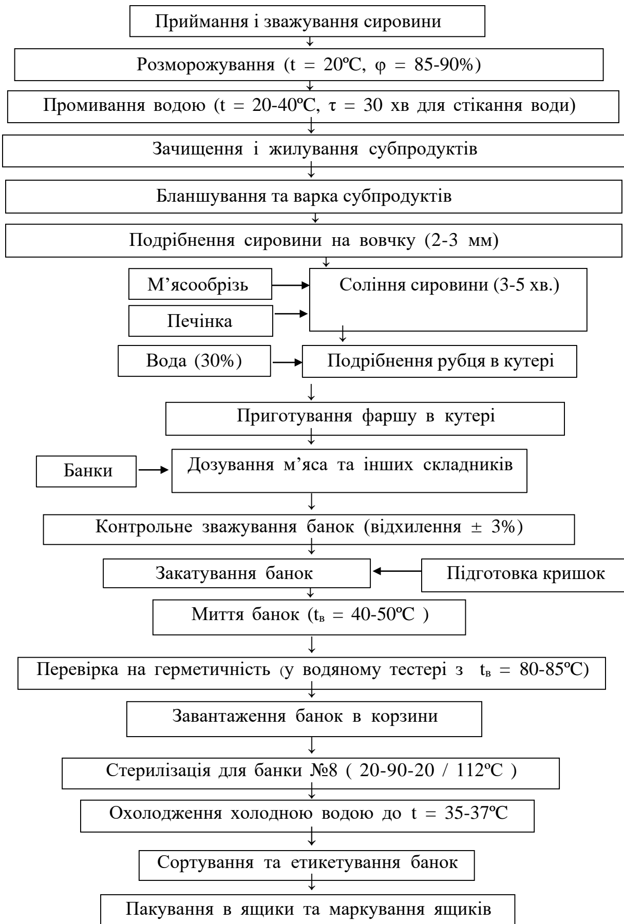
Рис. 5. Принципово-технологічна схема виробництва консервів “Паштет з свинячої печінки” та “Паштет печінковий з вершками”
