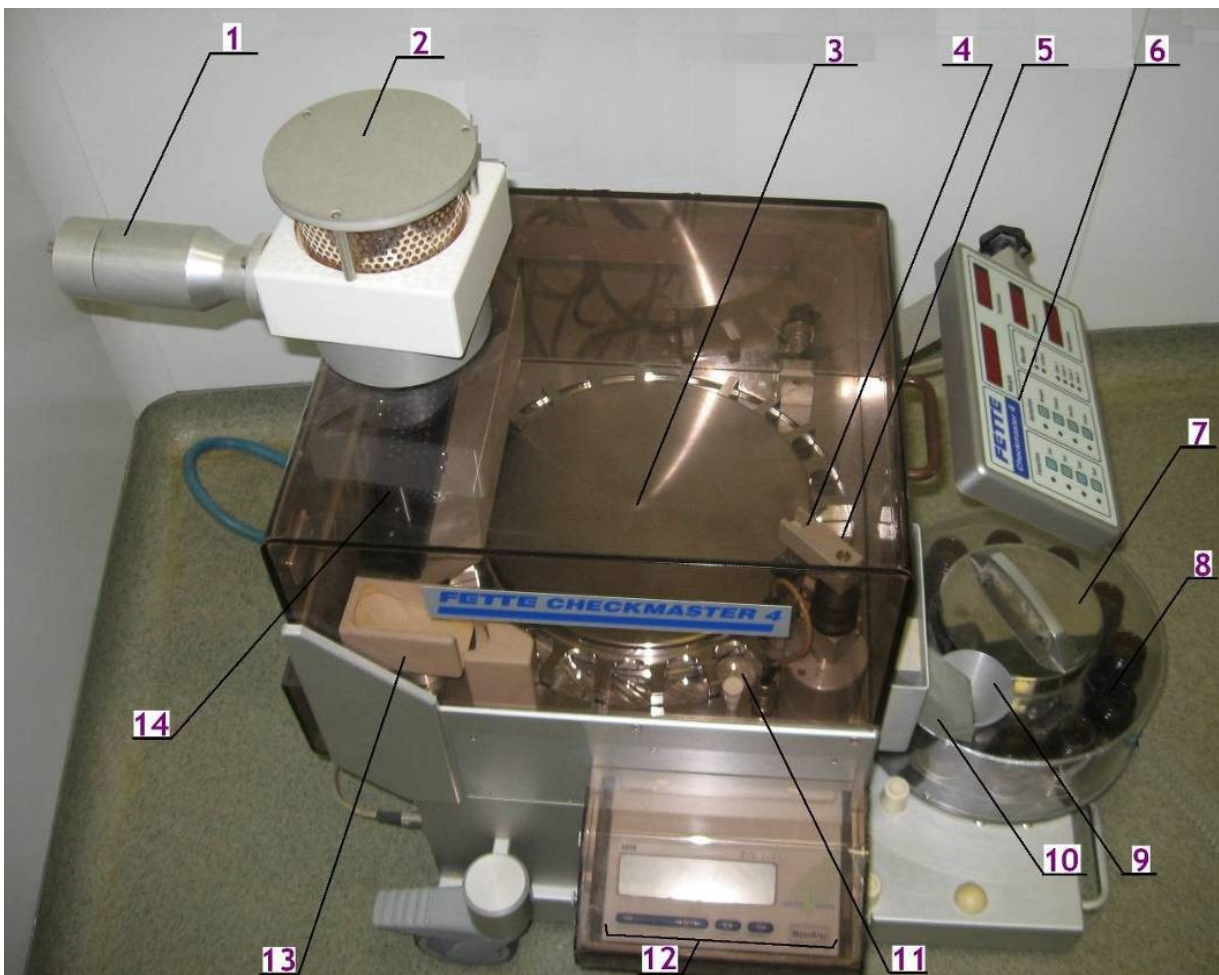
Рис. 7.13. Загальний вигляд пристрою для in-line контролю параметрів таблеток Checkmaster 4
