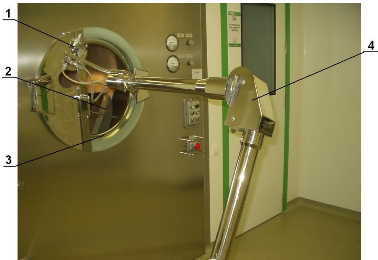
Рис. 7.14. Загальний вигляд установки для нанесення покриттів GS, тип HP / М 300 (основний модуль - вигляд спереду)
