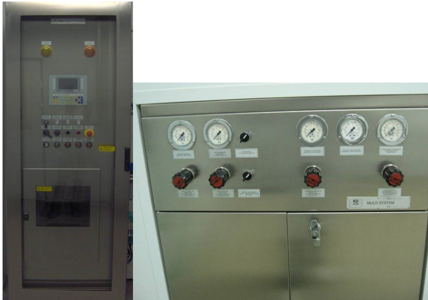
Рис. 7.15. Загальний вигляд установки для нанесення покриттів GS, тип HP / M 300.
