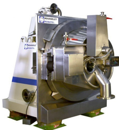
Рис. 3.2. Центрифуга горизонтальна EHL503(компанії «Біотехно»)
