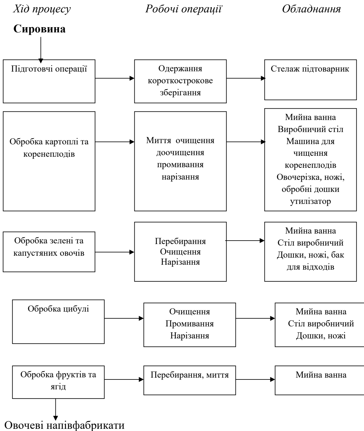
Рис.2.3 – Структурно-технологічна схема виробничого процесу овочевого цеху
