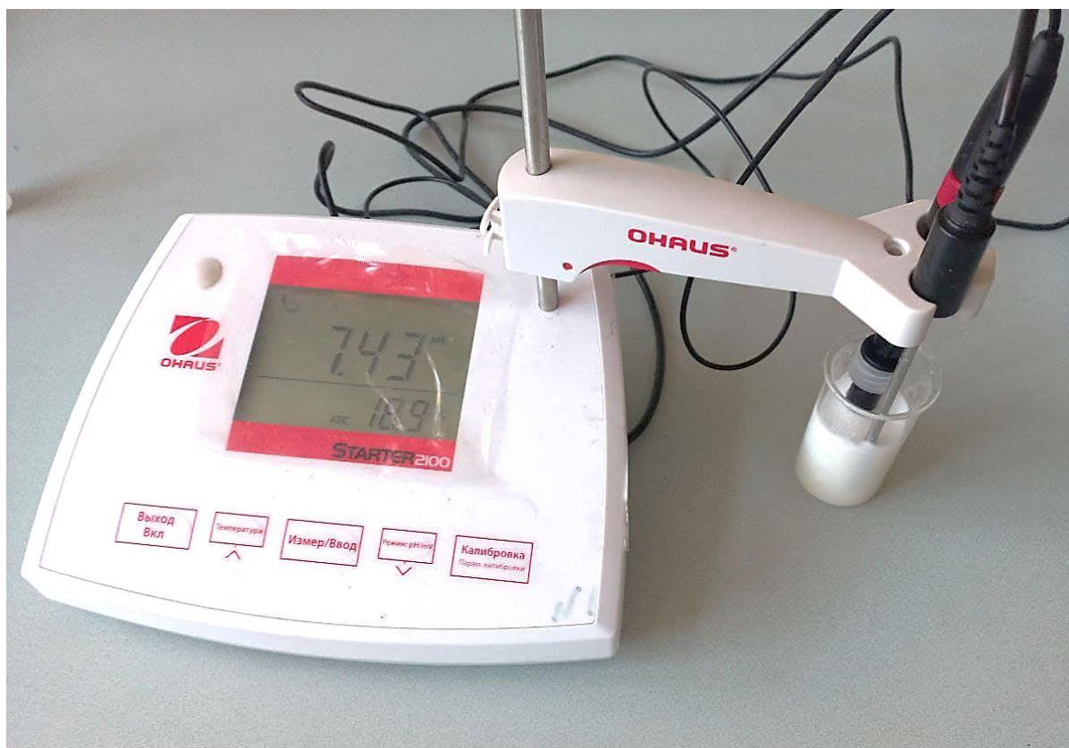
Рис. 2.27 – Вимірювання рівня рН середовища у харчовій емульсії з використанням гуміарабіку
