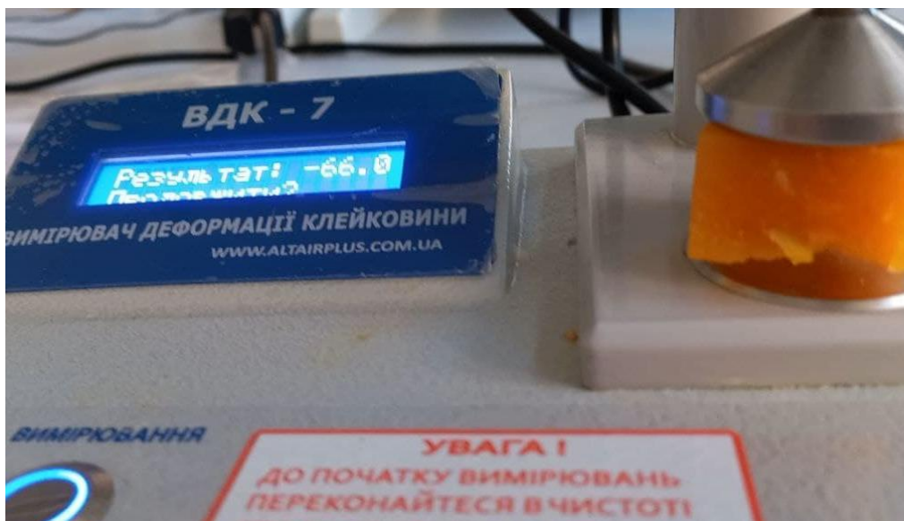
Рис. 2.21 – Процес вимірювання пружної деформації (МЗ №7).
