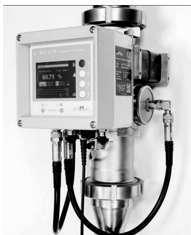
Рисунок 2.1 – Надвисокочастотний (НВЧ) аналізатор концентрації \mu -ISS
