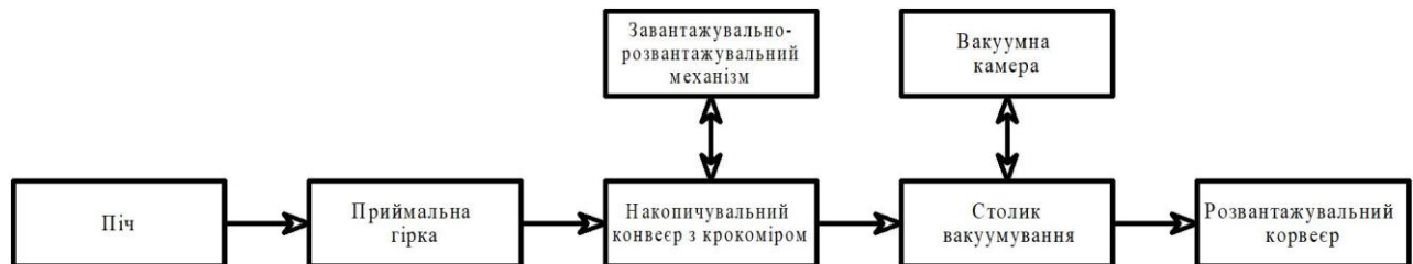
Рис. 4.5. Структурна схема апарата для вакуумного охолодження хліба в умовах потокового виробництва
