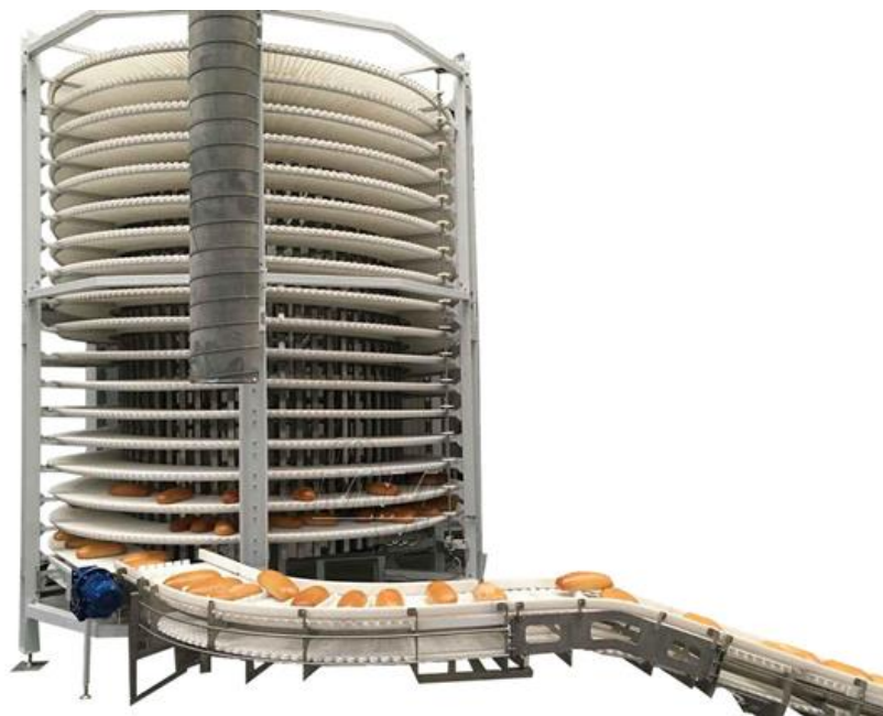
Рис. 1.2. Спіральний охолоджувач для хлібобулочних виробів
