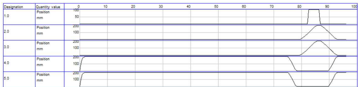
Рис. 5.4 Циклограма роботи елементів пневмоприводів.
