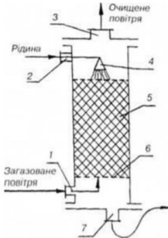
Рис 8.3. Схема башти-абсорбера: 1 — вхідний патрубок для загазованого повітря; 2 — патрубок для подавання рідини; 3 — вихідний патрубок для відведення очищеного повітря; 4 — розбризкувач; 5 — шар рідини з насадкою; 6 — сітка; 7 — вихідний патрубок для відведення забрудненої води.
