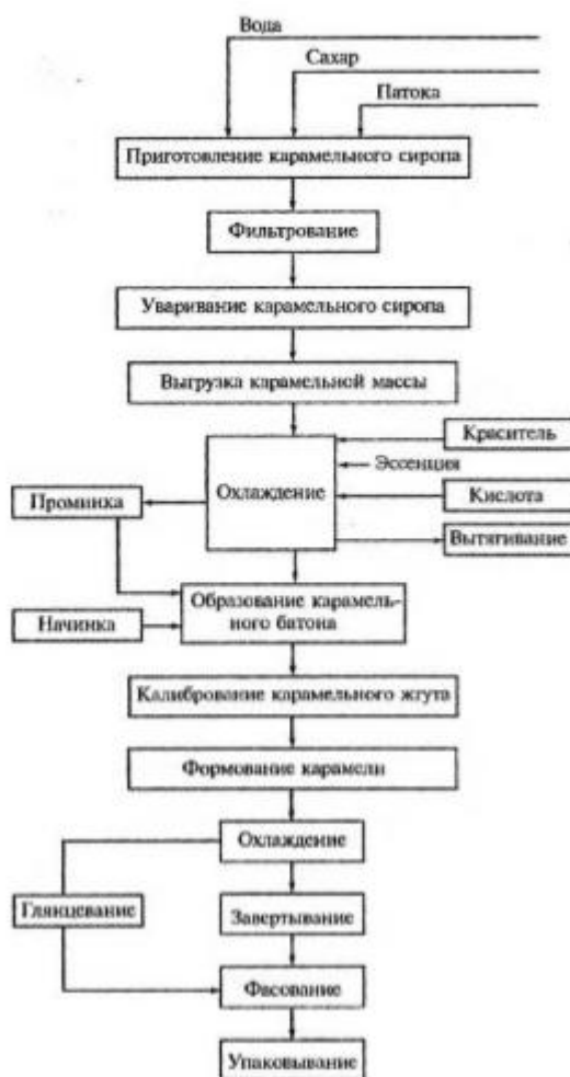
Рис 2.1. Принципова схема виготовлення льодяникової карамелі
