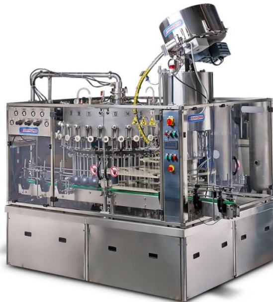
Рис. 1.2. Моноблок фасувально–закупорювальної машини з попередніми обполіскуванням
