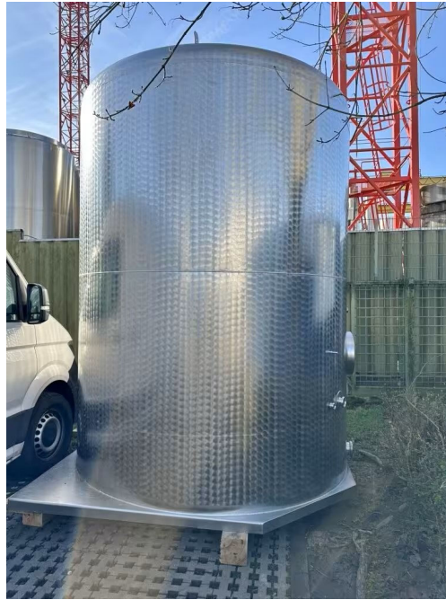
Рис. 3.4 – Ємність 10000LiterTank з нержавіючої сталі з сорочкою Ємність складається:
