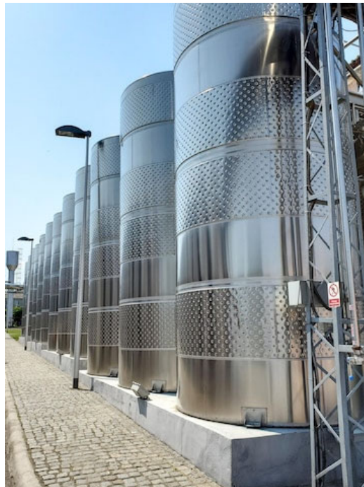
Рис. 3.8 – Ємності з сорочкою виготовлені з нержавіючої сталі марки AISI 304.
