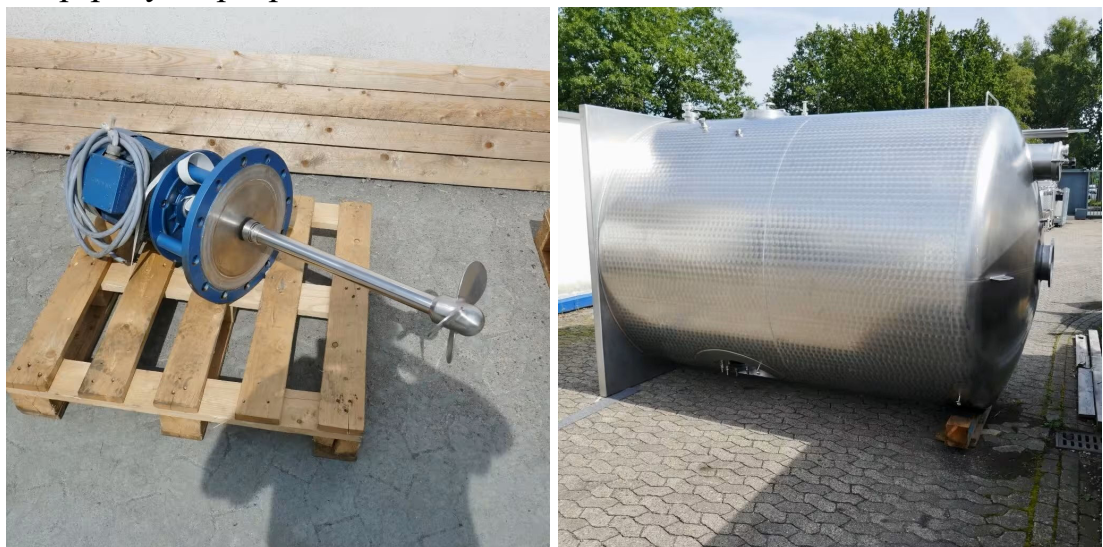
Рис. 3.5 – Ємність 10000LiterTank з нержавіючої сталі з сорочкою
