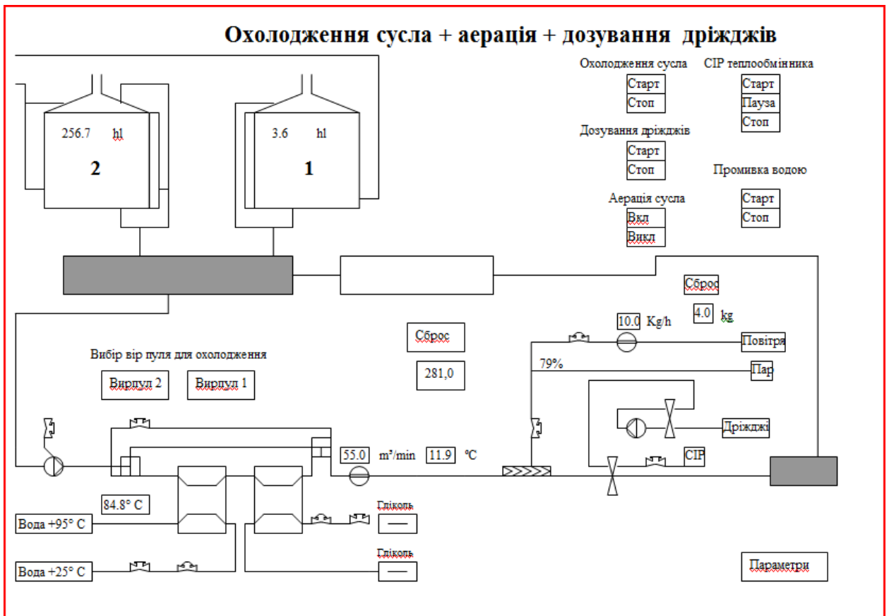
Рис. 1.6. Приклад мнемосхеми процесу охолодження сусла (система Alfa Laval).
