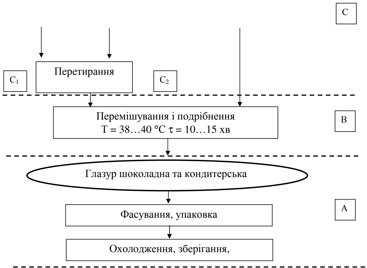
Рис. 2 – Функціональна схема виготовлення шоколадної та кондитерської глазури для кондитерських виробів, що збагачена на гемове залізо: С – підготовка сировини до виробництва; С 1 – підготовка традиційних інгредієнтів рецептури; С 2 – підготовка жирового напівфабрикату з використанням дієтичної добавки «Гемовітал»; В – приготування рецептурної суміші; А – товарне оформлення готового напівфабрикату
