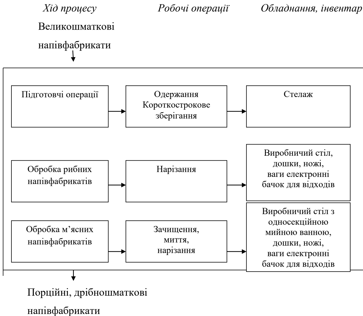
Рис. 2.4 - Структурно-технологічна схема виробничого процесу м'ясо-рибного цеху
