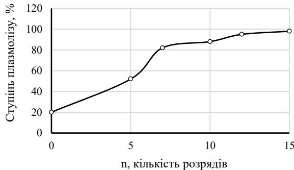
Рис. 5. Зміна ступеня плазмолізу тканини цукрового буряка при ЕІО залежно від кількості розрядів
