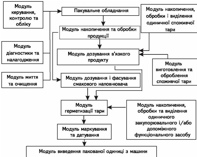
Рис. 1. Структура машини для пакування в'язких харчових продуктів у споживчу тару
