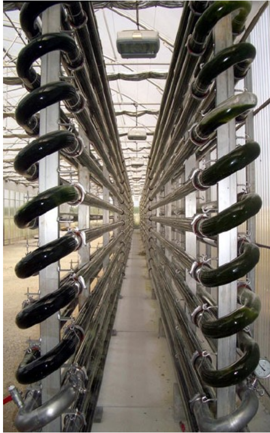
Рис 3.2. Конструкція трубчастого фотобіореактора[54]
