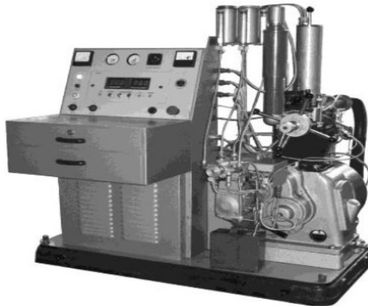
Рис. 6.4. Установка ИДТ-90 для визначення цетанового числа[79, 93].
