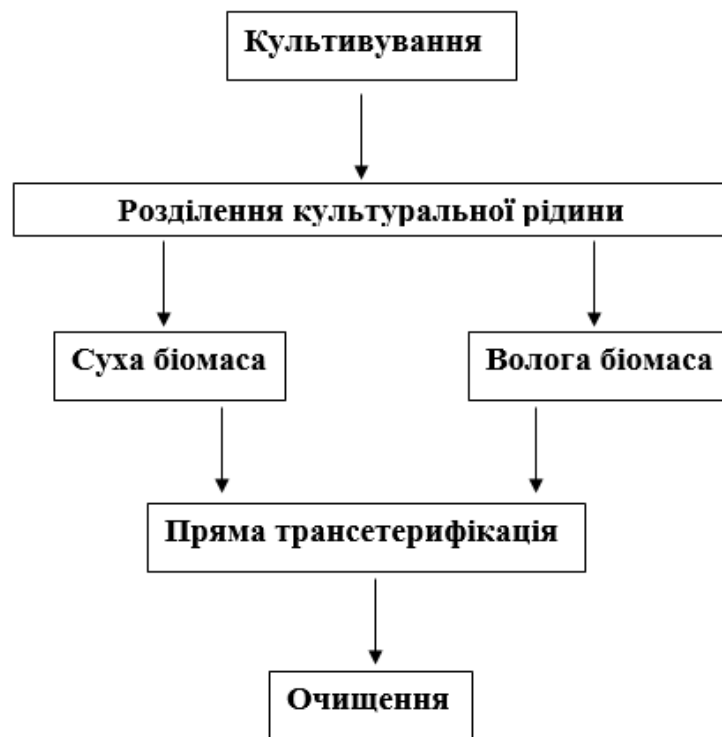
Рис. 3.5. Схема одержання біодизеля методом прямої трансетерифікації
