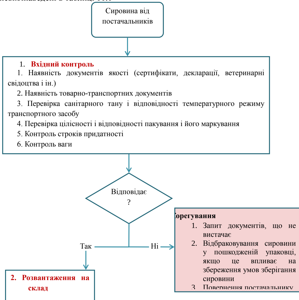
Рисунок 11.1. Блок-схема приймання та зберігання сировини БС1
