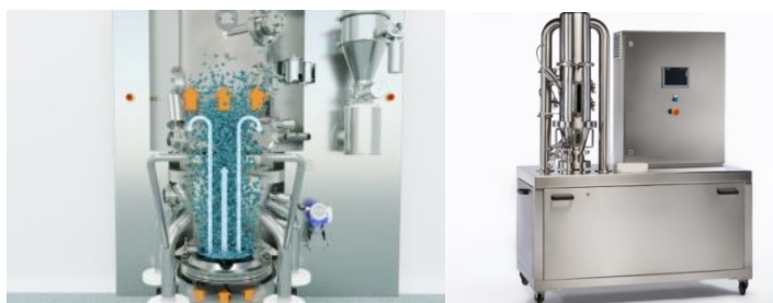
Рис. 5.5. Схема роботи, зовнішній вигляд сушарки з псевдозрідженим шаром [65]
