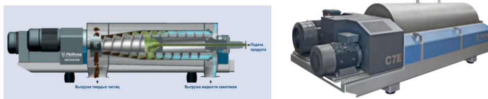
Рис. 5.1. Схема роботи, зовнішній вигляд та графічне позначення на апаратурній схемі центрифуги-декантера [59]
