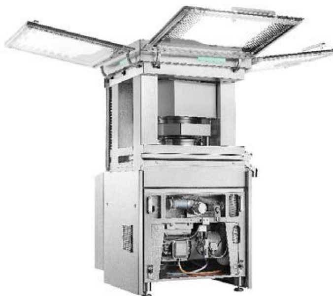
Рис. 1. 1. FETTE P1010 - таблетпрес для виробництва невеликих партій продукту
