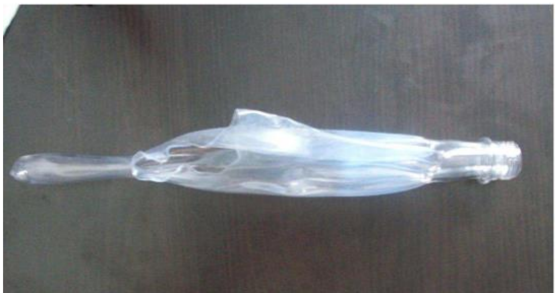
Рис. 1.7. Дефект «руйнування пляшки при видуванні»
