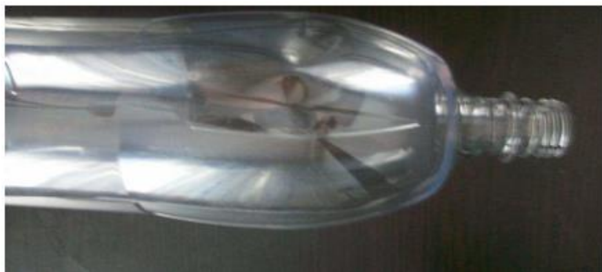
Рис. 1.10. Дефект «надлишок матеріалу на горловині»
