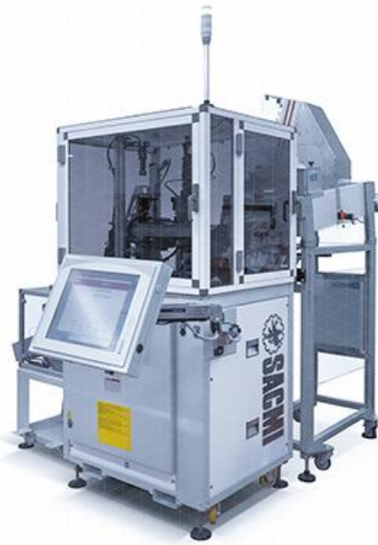
Рис. 2.3. Пристрій PV002С, для оцінки якості ПЕТ-преформ
