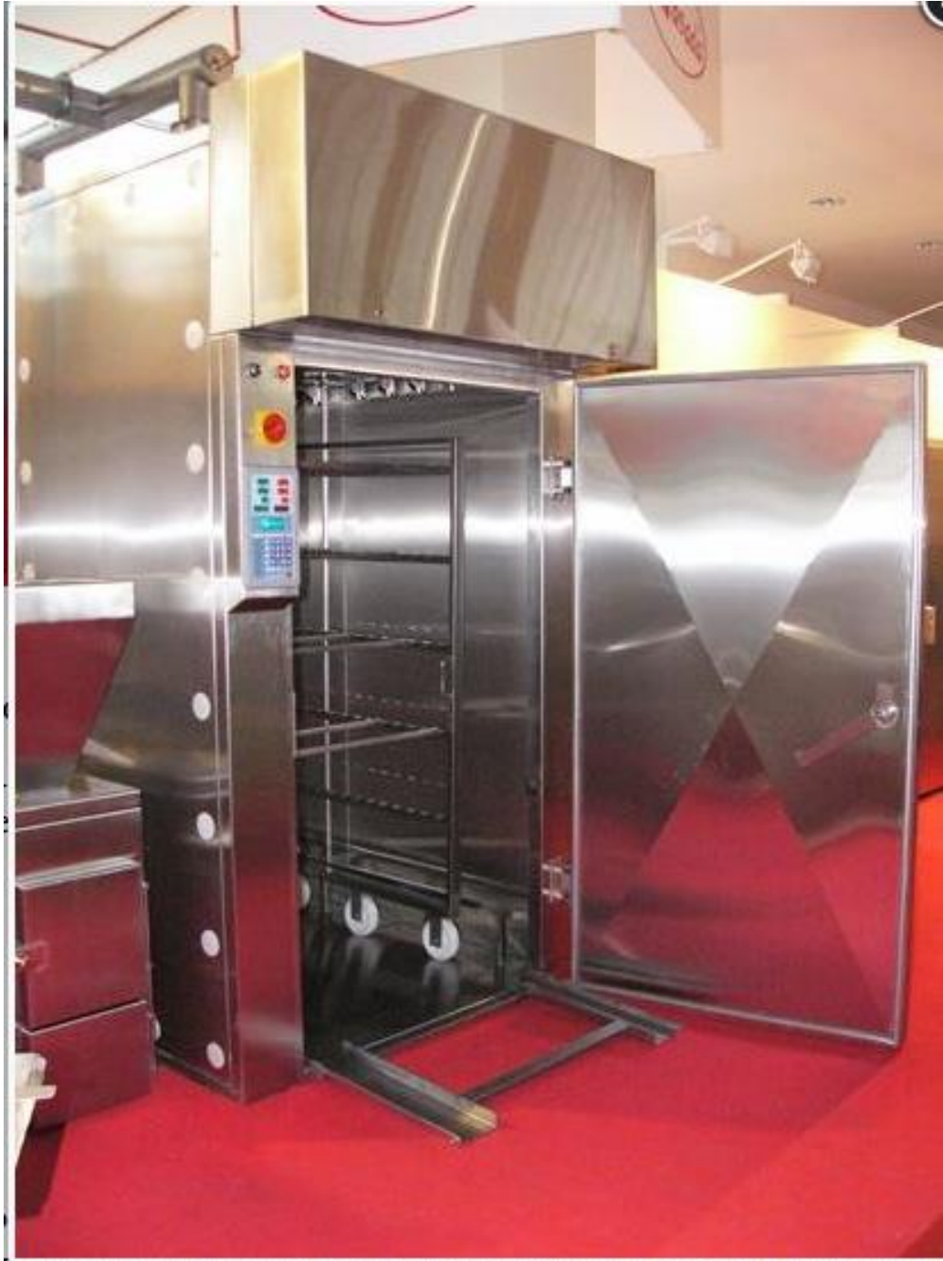
Рис.5. Загальний вигляд коптильно-варильної камери KW ZASADA.
